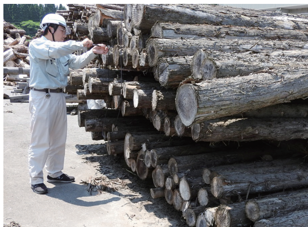
FAKOPPを用いた両木口間のSPT計測
